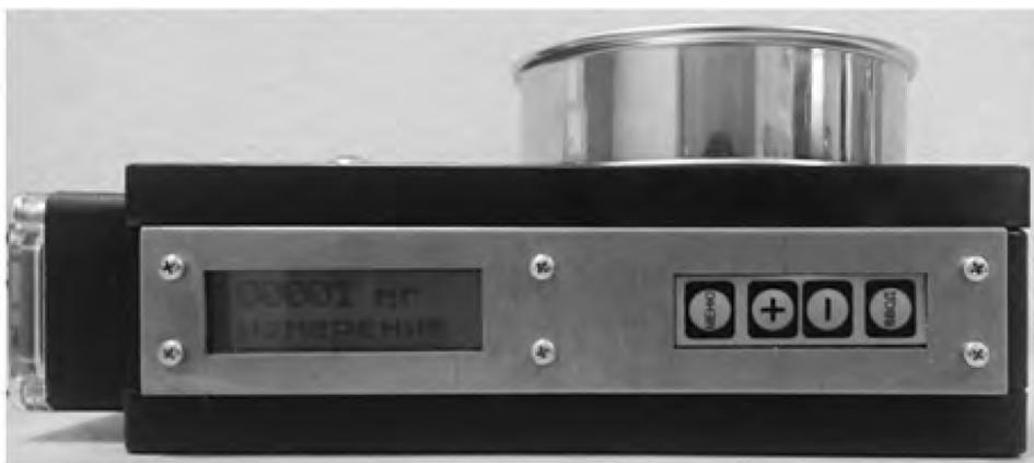
Рисунок 3.3 – Датчик интенсивности пылеотложения ДИП-1
