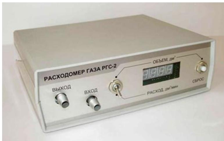
Рисунок 4.5 – Расходомер-счетчик газа РГС-2
