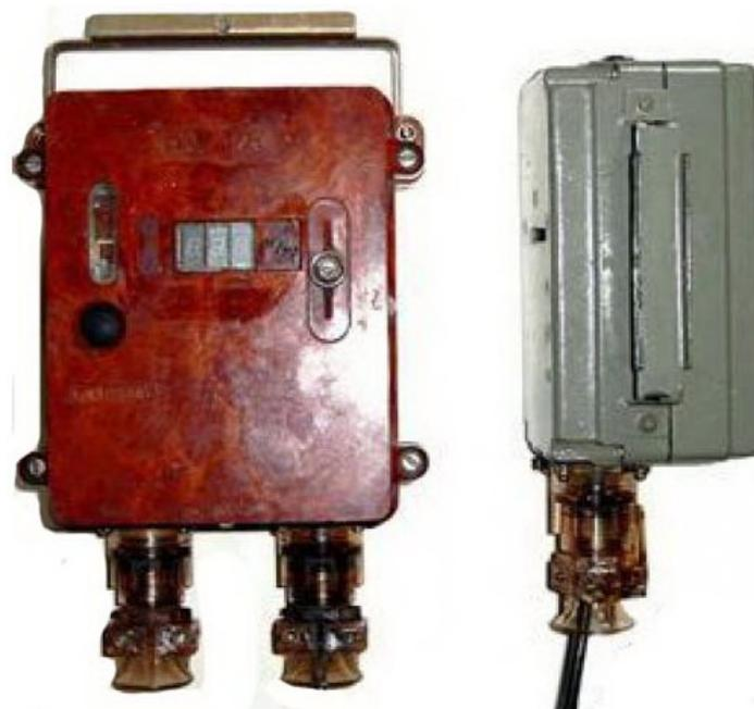
Рисунок 1.3 – Стационарный датчик ДЗВ-500
