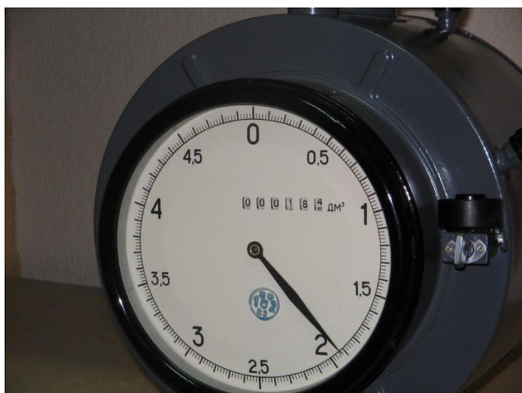
Рисунок 4.6 – Счетчик газа барабанного типа ГСБ-400
