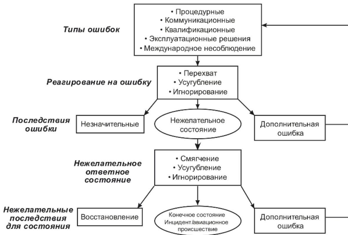
Рисунок 1.6 – Модель управления ошибками экипажа
